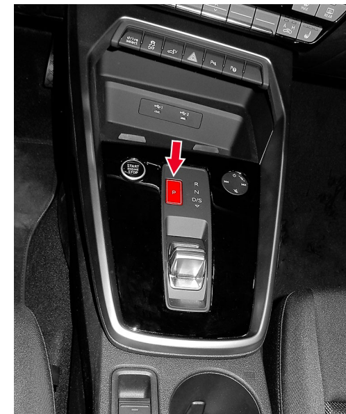
Veicolo con cambio automatico senza leva selettore: premere il pulsante "P"
