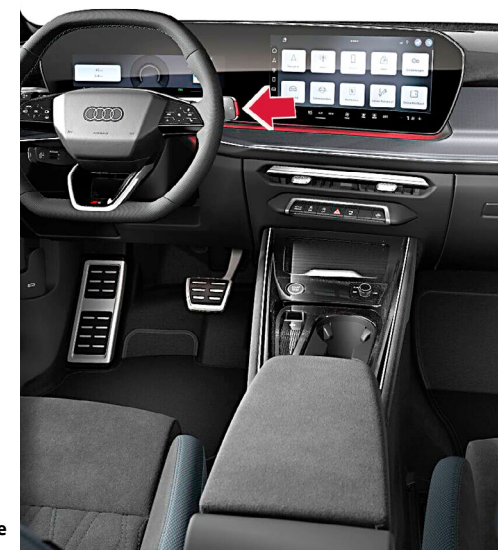
Veicolo con cambio automatico senza leva selettore: premere il pulsante "P" sulla leva destra del piantone dello sterzo
