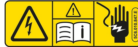
Exemples d'autocollants de mise en garde sur des véhicules haute tension.
