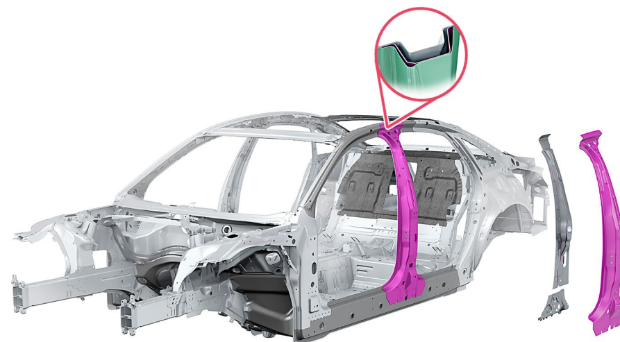
Montant B avec structure multicouches
