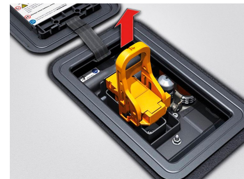
Relever le levier et retirer la fiche par le haut.
