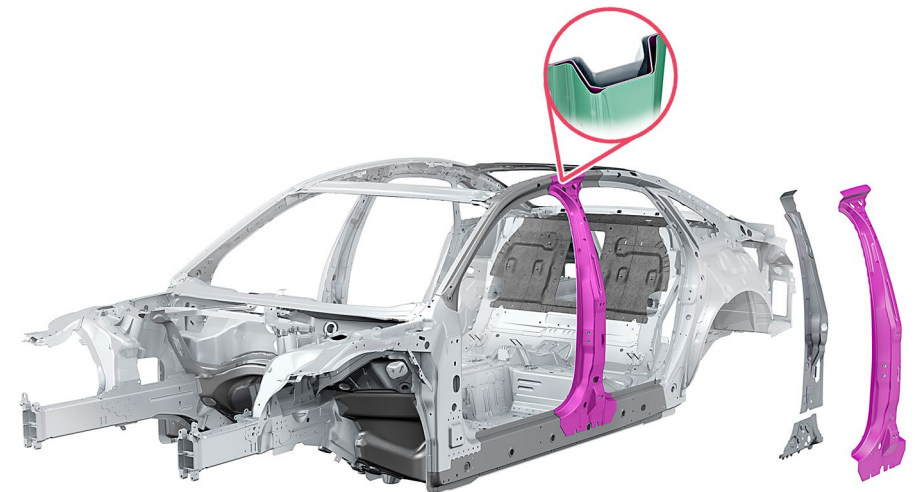
B-Säule mit mehrschaligem Aufbau
