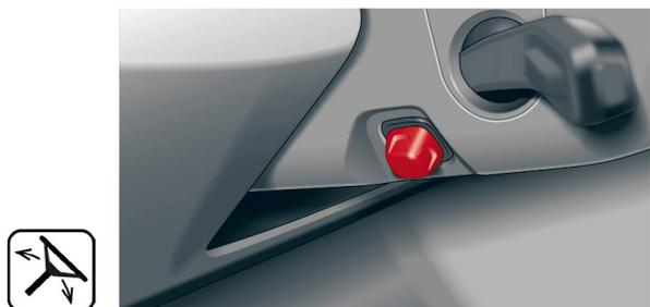
Réglage électrique de la position du volant
