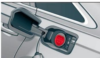
Prise de recharge A6 « TFSI e » sur la partie latérale arrière
