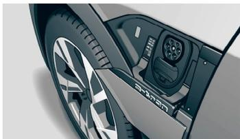
Toma de carga "e-tron" en la aleta o en el panel lateral (posible en ambos lados)
