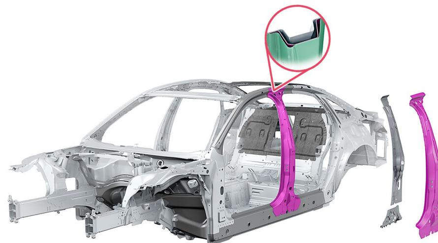
Pilar B con estructura multicapa
