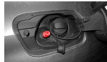
Toma de gas natural en la boca de llenado del depósito
