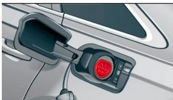
Toma de carga A6 "TFSI e" en la parte posterior del lateral
