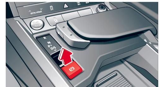
Interruptor del freno de estacionamiento eléctrico
