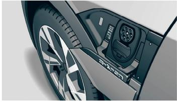
Ladeanschluss „e-tron“ am Kotflügel oder Seitenteil (beidseitig möglich)
