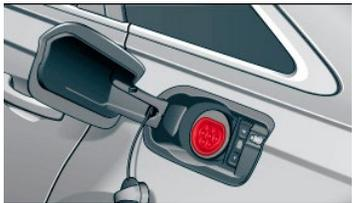
Ladeanschluss A6 „TFSI e“ am Seitenteil hinten
