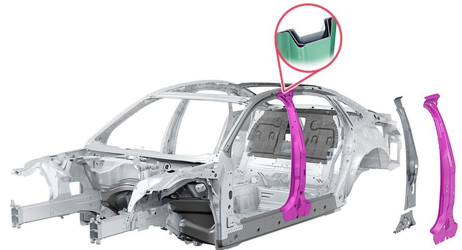
B-Säule mit mehrschaligem Aufbau
