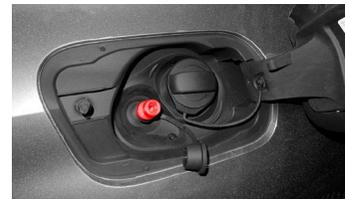
Erdgas-Anschluss am Tankeinfüllstutzen
