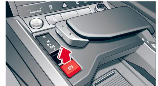
Schalter der elektrischen Feststellbremse
