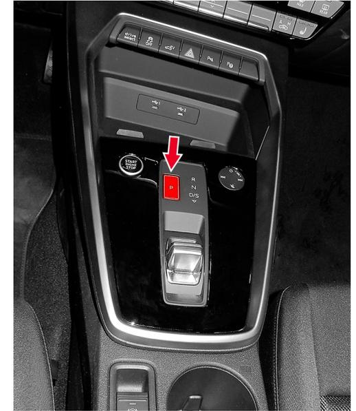
Fahrzeug mit Automatik-Getriebe ohne Wählhebel: „P“-Taste drücken
