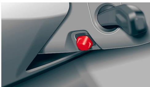
Einstellung Lenkradposition elektrisch
