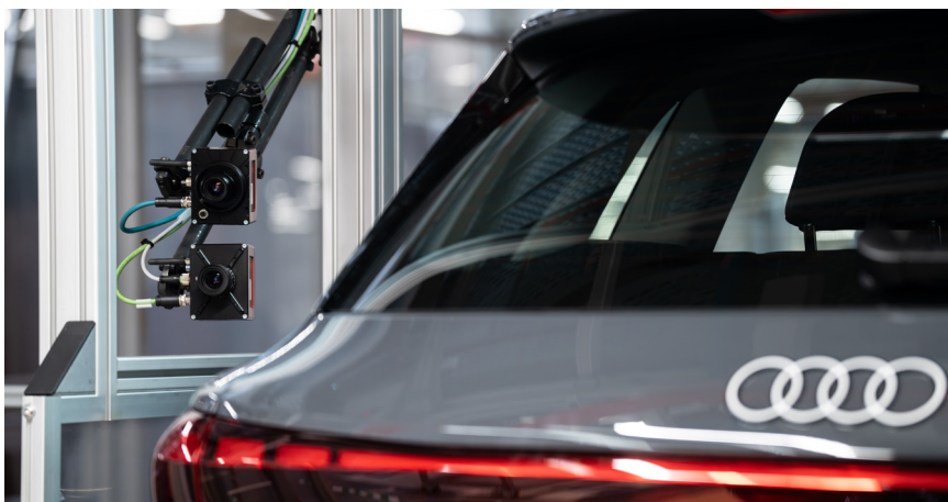
IRIS: Das Kamerasystem mit bildverarbeitender KI spart wertvolle Produktionszeit.
