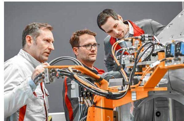
Peter Stechel (Leiter Analysezentrum, l.), Ralf Hofmeister (Technikmeister Messtechnik Karosseriebau) und Thomas Reeb (Leiter Messtechnik, r.) kontrollieren Sensoren einer Inline-Messstation im Werk in Ingolstadt.
