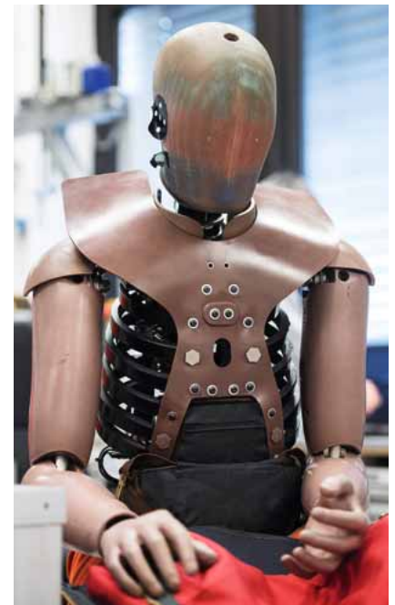
Der THOR-M: die nächste Generation der Dummies für künftige frontale Crashtests. Nachfolger des Dummytyps H3. Er hat bis zu 130 Messpunkte, die Crascheinflüsse und -einwirkungen messen. Sowohl der Brustkorb (Thorax) als auch das Becken wurden verbessert. Gesamtzahl der größeren Einzelteile: etwa 300.
