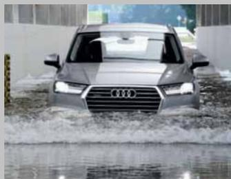
**INKA-Test:** Im Ingolstädter Korrosions- und Alterungstest wird in 19 Wochen ein zwölfjähriges Autoleben simuliert: Hohe Luftfeuchtigkeit, Hitze und Kälte in Klimakammern; Schotter, Schlamm und Salz auf den Teststrecken – jedes Audi Modell wird nach dem Härtetest komplett zerlegt und auf Korrosion, Alterung und Verschleiß überprüft.
