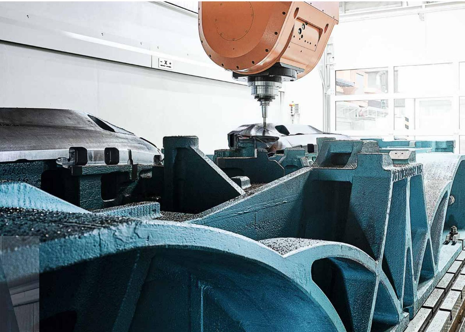
*02 // VOR, ZURÜCK, VOR, WIEDER ZURÜCK. Unerbittlich fährt die Hochleistungsfräswendeplatte in jede Ecke. Nur Diamant ist härter. Metallspäne bedecken die sanften Wölbungen, immer mehr werden es. Hier noch ein tausendstel Millimeter, da eine Unebenheit, dort ein Übergang. Alles muss weg. Nichts darf stören.*
