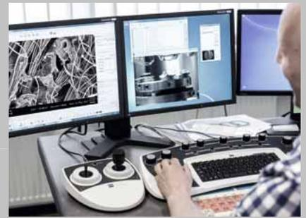
**Analysemethoden:** Mithilfe der Rasterelektronenmikroskopie (REM) können die Mikrostrukturen von Bruchflächen, Verschleißbildern und Oberflächen analysiert werden. Das punkt- und linienförmige Abrastern der Proben mit einem gebündelten Elektronenstrahl erlaubt 20.000- bis 500.000-fache Vergrößerungen. Die zusätzlich integrierte Ionenstrahlschneidtechnik (FIB) ermöglicht Schnitte im Mikrometerbereich mit punktgenauen Tiefenanalysen des Materialaufbaus.
