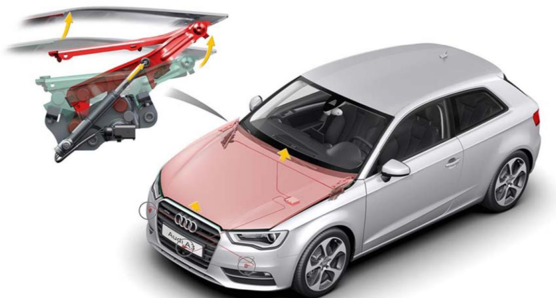
Ilustracja: Schemat układu ochrony pieszych
