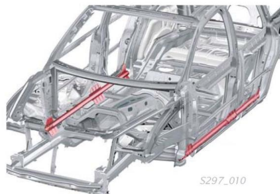
Ilustracja: Przykład progu drzwi ze wzmocnieniem rurowym
