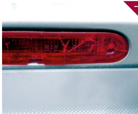
Pęknięcia przezroczystej osłony.
