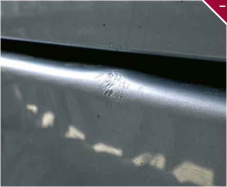
Odształcenia i deformacje zderzaków.
