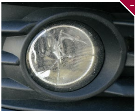
Uszkodzenia reflektorów i lamp ograniczające ich funkcjonalność, niezależnie od wielkości uszkodzenia.
