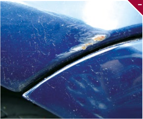
Wszelkie ślady korozji, niezależnie od rozmiaru i pochodzenia.
