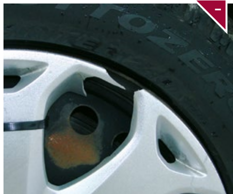
Uszkodzenia kołpaków, np. pęknięcia, deformacje, ubytki. Brak kołpaka/kołpaków lub kołpaki różnego typu.
