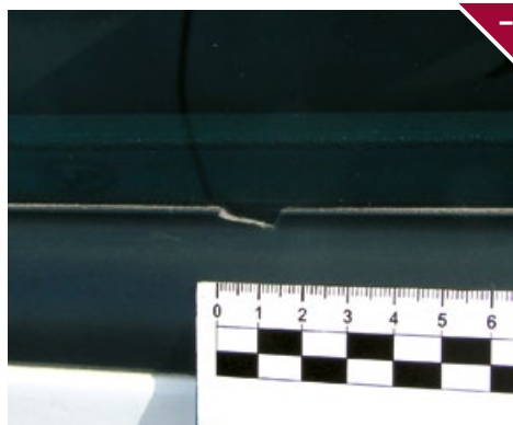
Uszczelki szyb niekompletne, z ubytkiem materiału lub odkształcone, niezależnie od ich wielkości i miejsca występowania.
