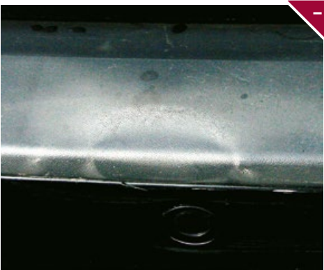
Ślady po odształceniach zderzaków lub pęknięcia powłoki lakierniczej.
