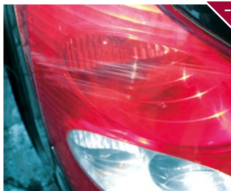
Zarysowania i odpryski.
