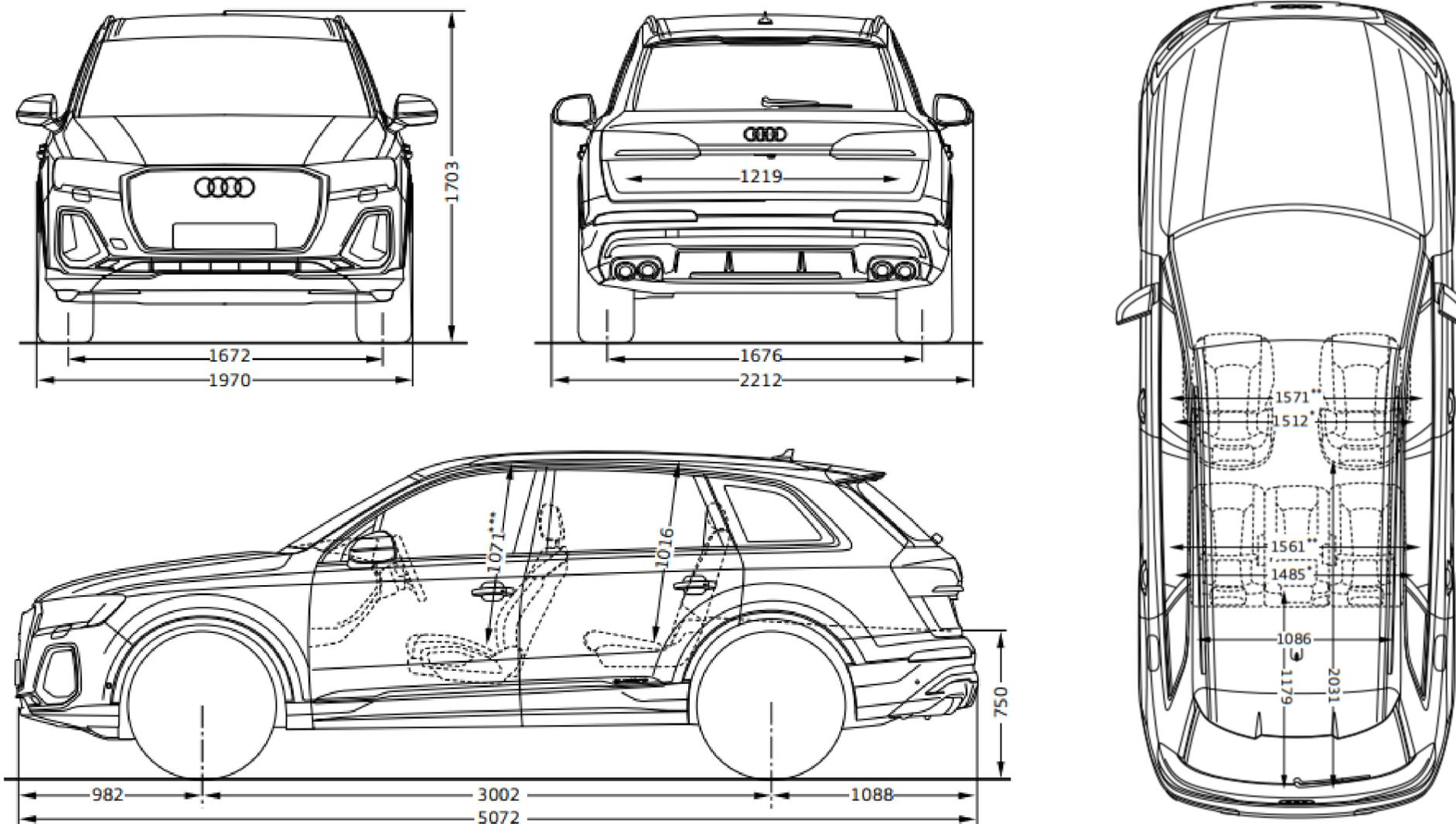
Toutes les cotes sont indiquées en millimètres. <sup>1</sup>Largeur aux épaules, <sup>2</sup>Largeur aux coudes, <sup>3</sup>Espace libre maximal, <sup>4</sup>Hauteur du véhicule avec antenne, <sup>5</sup>Niveau normal
